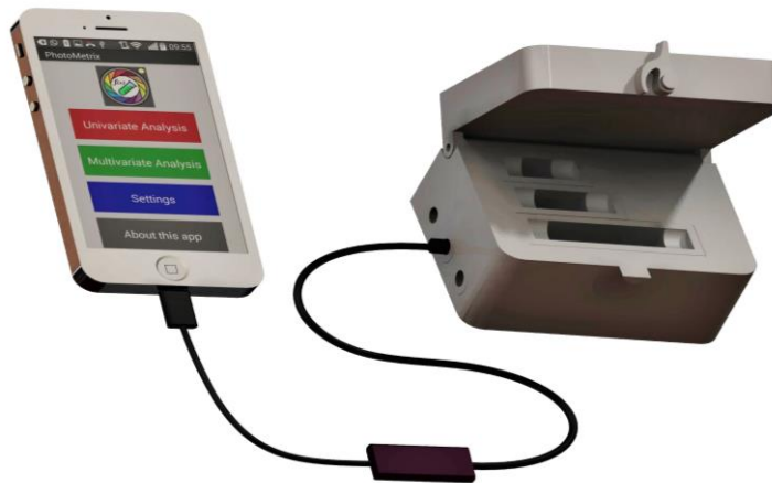
Figura 3 – Protótipo para aquisição de imagens com três cubetas (10, 20 e 50 mm).
