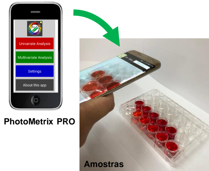
Figura 2 – Aquisição de imagens utilizando o PhotoMetrix PRO.
