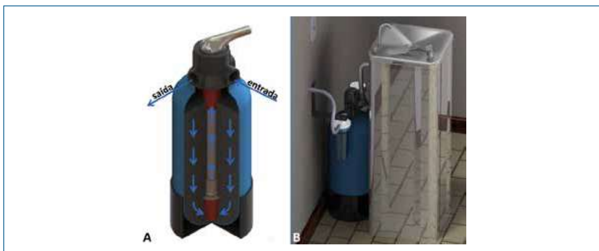
Figura 1 – Ilustração do sistema de filtração proposto nesse estudo. A – Filtro de carvão ativado de osso montado em uma estrutura de fibra de vidro (Structural® PolyGlass®); B – Filtro instalado em um bebedouro escolar.
